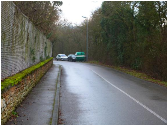
P20 : visibilité limitée côté sud pouvant être améliorée en rabottant l'avancée de mur
